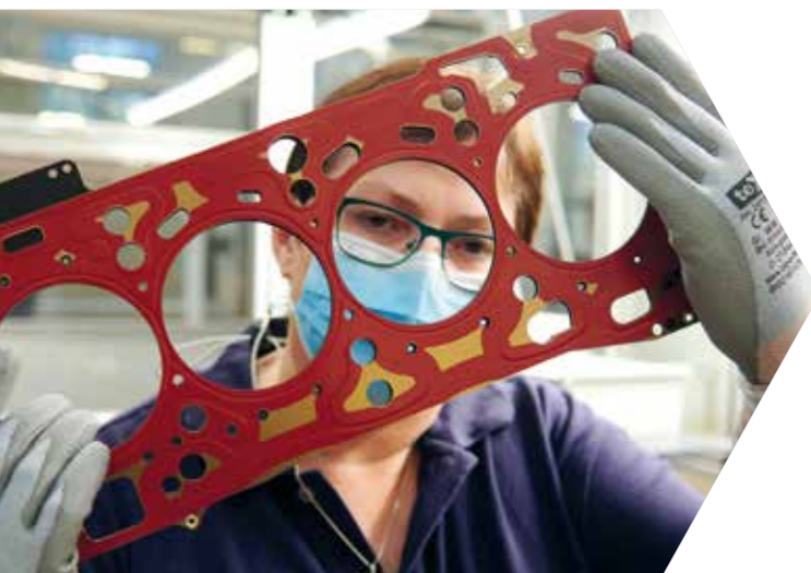
Montage einer Zylinderkopfdichtung am Standort Limburg.
